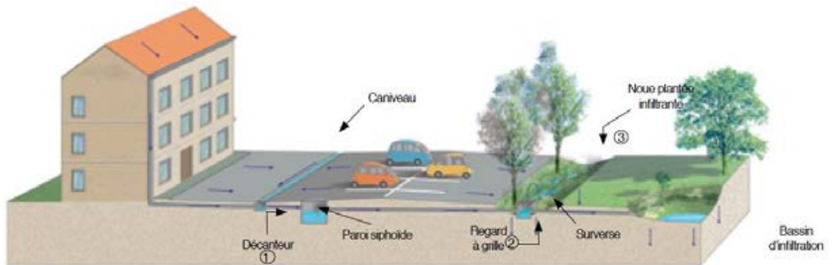
Exemple d'ouvrage de prétraitement en amont d'un bassin d'infiltration
